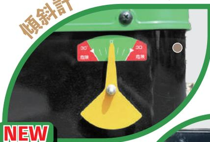
機体に傾斜計が付いたことで、作業限界を一目で確認。最大作業角度：全方位 30°
