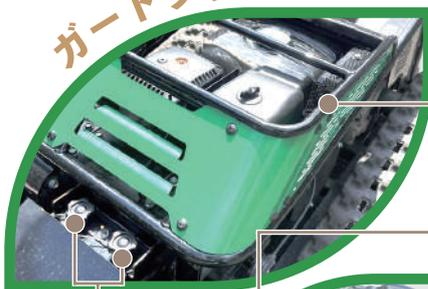
ガードフレームのデザインを一新。給油時、エアクリーナーのメンテナンス時の作業性が向上。
